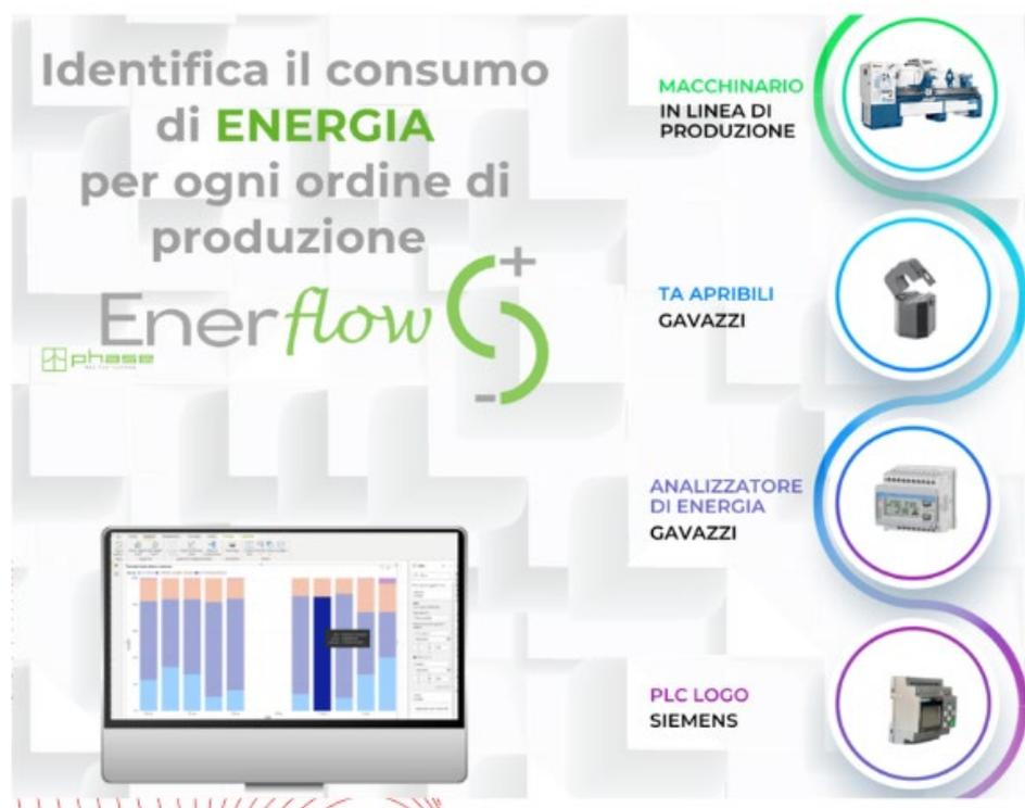
Il modulo è progettato per monitorare i consumi delle macchine utensili, associandoli alle singole commesse di produzione e raccogliendo i dati per analizzare l'efficienza energetica.
